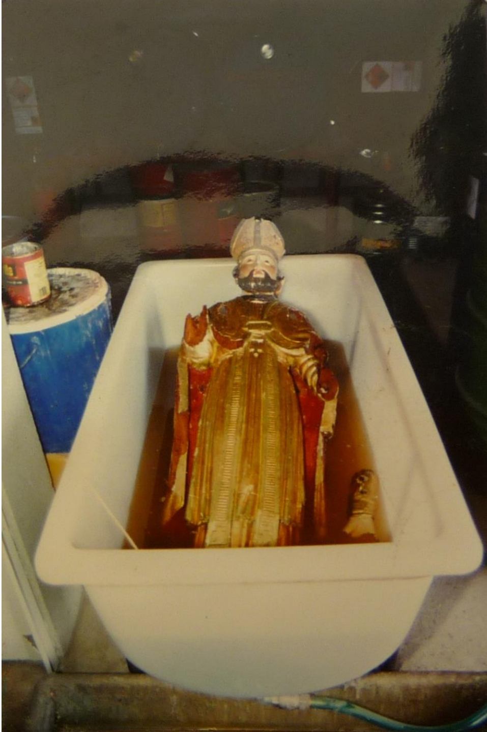
La polymérisation par imprégnation (consolidation du matériau par interpénétration moléculaire).
